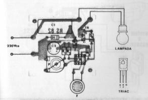
Con questo KIT si realizza un dispositivo sensibile alle variazioni di luce; infatti appena la luce scende al di sotto di un certo livello l'uscita del circuito integrato assume uno stato logico alto il quale mette in conduzione il TRIAC che porta la tensione a 220 Vea sul carico. Questo circuito,grazie ad un particolare riduttore di tensione, funziona direttamente a 220Vea e il carico massimo applicabile è di 500 W.
